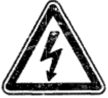
Gevaar voor elektrische spanning
